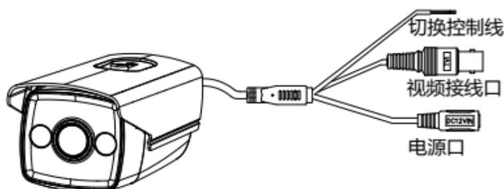
图2-2 II型摄像机概览图
