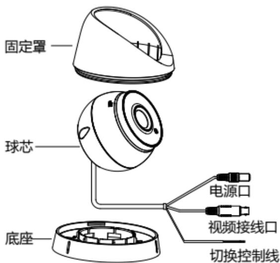
图2-1 I型摄像机概览图
