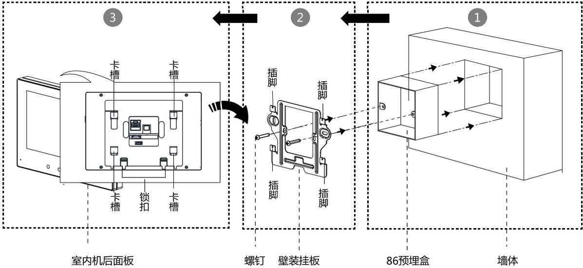
图2-2 安装室内机
