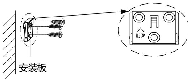
图1-3 固定安装板
