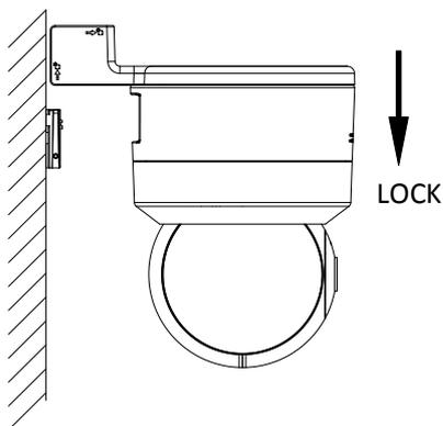
图1-4 安装摄像机
