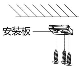
图1-5 固定安装板
