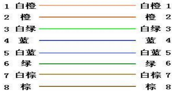
网络交叉线：网络交叉线线序如下图所示，应用于网络摄像机的网口与 PC 机相连。
