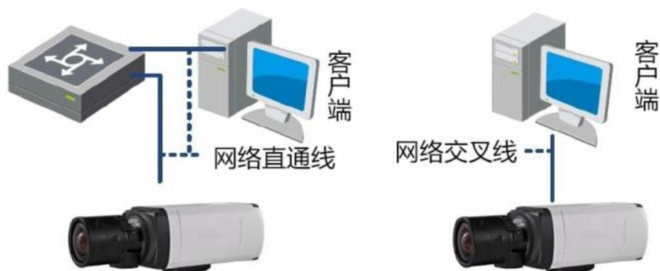
图2-1 有线连接示意图
