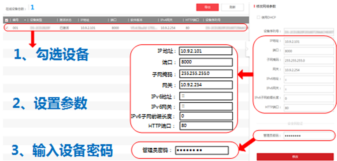
图 5-3 修改设备 IP 地址
